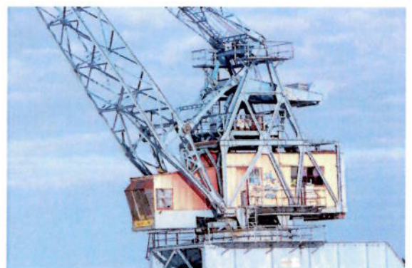
Kranens portal och förarhytt med maskinrum. Förarhytten klädd med blekt bandplåt.
