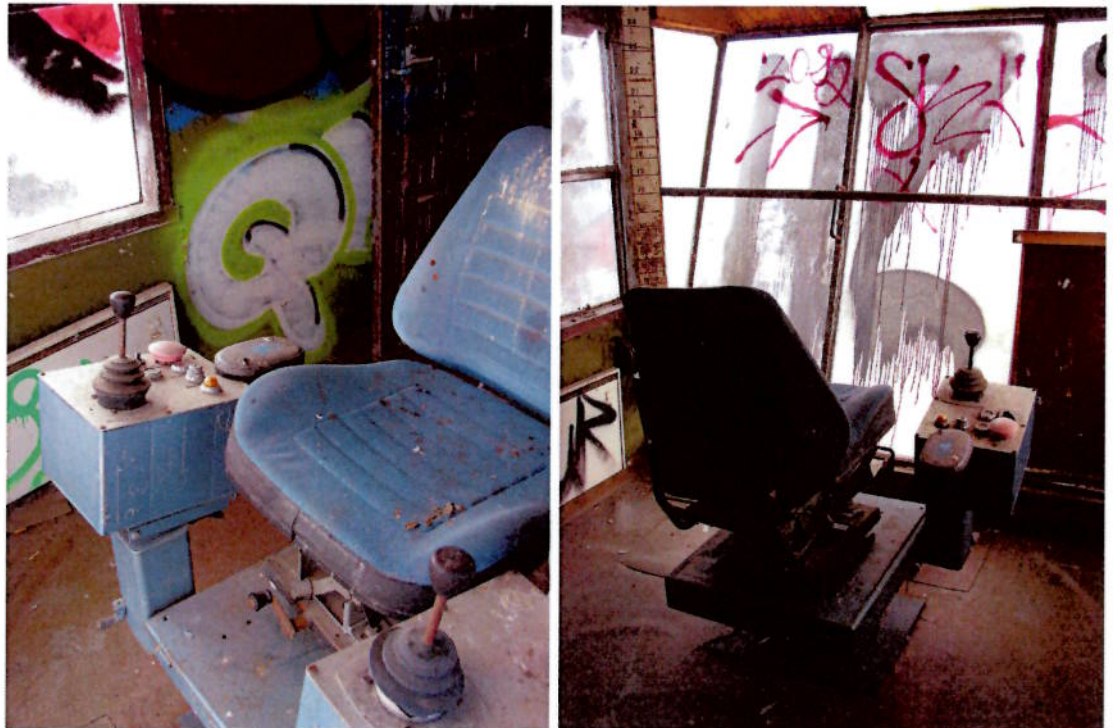
Bilder från förarhytten – stolen och spakarna tillhör 1980-talets bidrag. Observera mätstickan för kranens utlägg i hörnet till vänster om förarplatsen på högra bilden.
