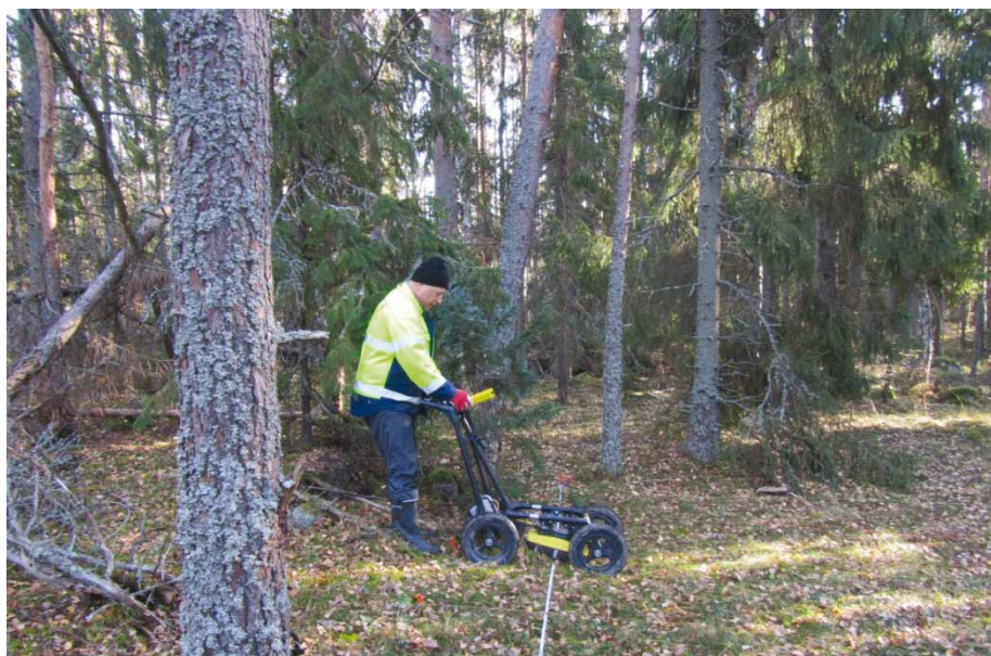
Figur 38. Lars Winroth manövrerar georadarn längs ett utstakat rutsystem söder om husgrunden. Foto: Bo Ulfhielm, Länsmuseet Gävleborg.
